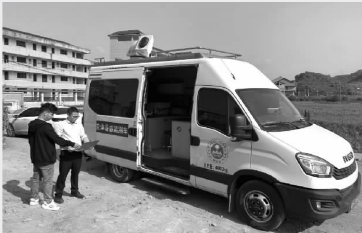
近日,广丰区生态环境局利用走航监测车对园区、城市主干道和重点工业企业等开展全天候全方位颗粒物、VOCs走航监测。走航车作为大气污染防治“侦察兵”,可在行驶中随时对环境空气中的污染源进行快速检测,锁定排放区域。在走航期间,工作人员还对重点区域企业开展现场检查,对企业存在问题提出靶向整改建议,提升“治气管气”精细化水平。
